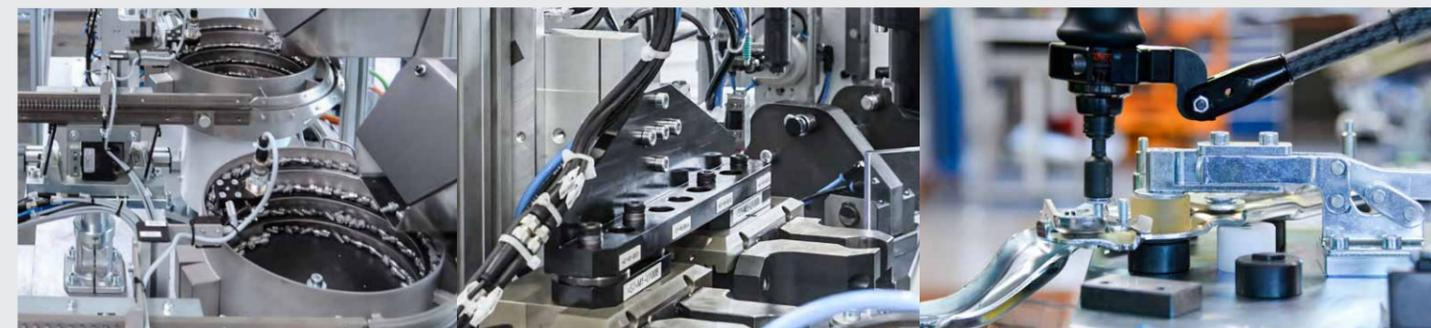
z. B.: Zuführsysteme für die lagerichtige Bauteilbereitstellung
