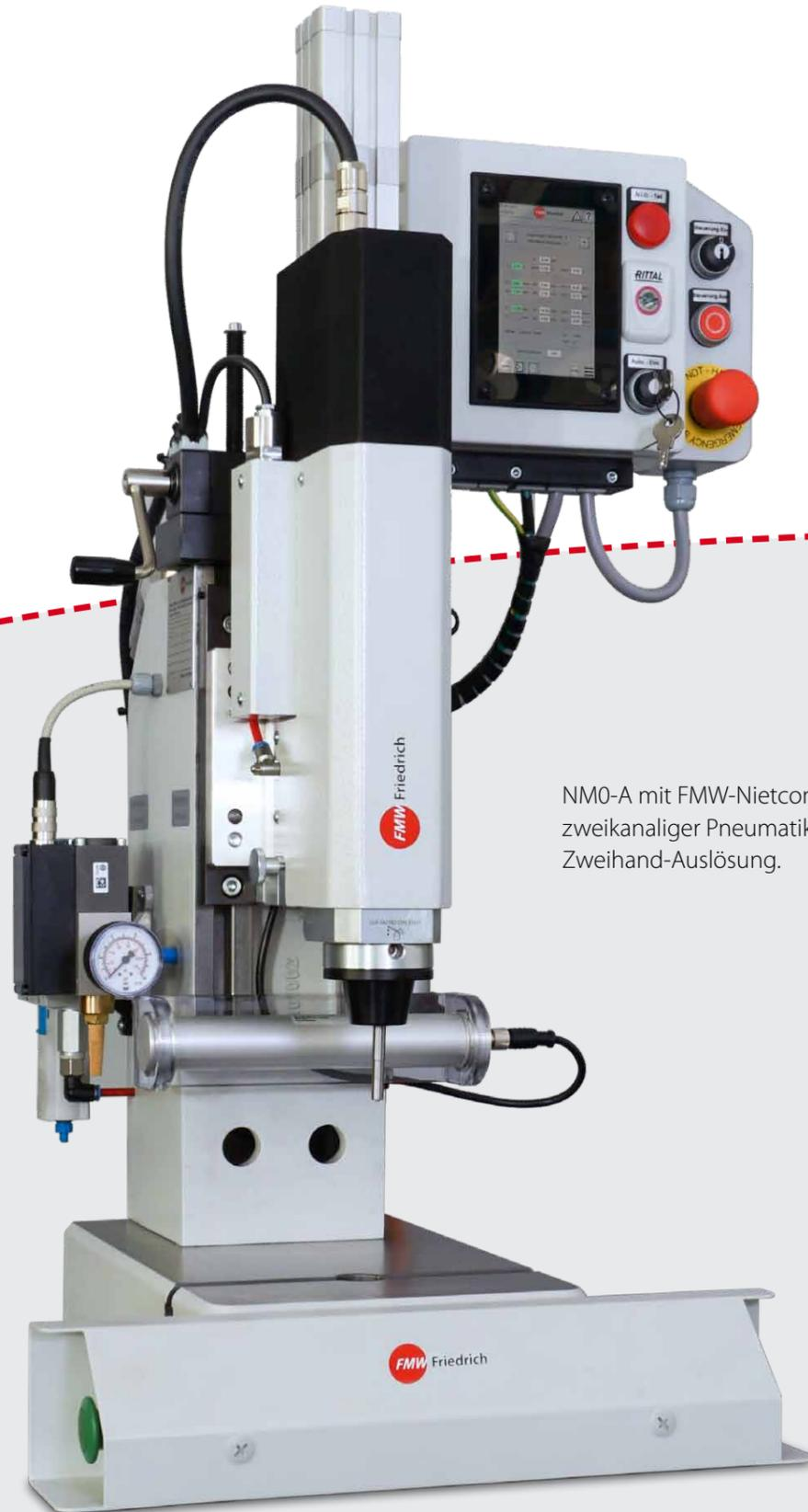
NM0-A mit FMW-Nietcontrol, zweikanaliger Pneumatik und Zweihand-Auslösung.
