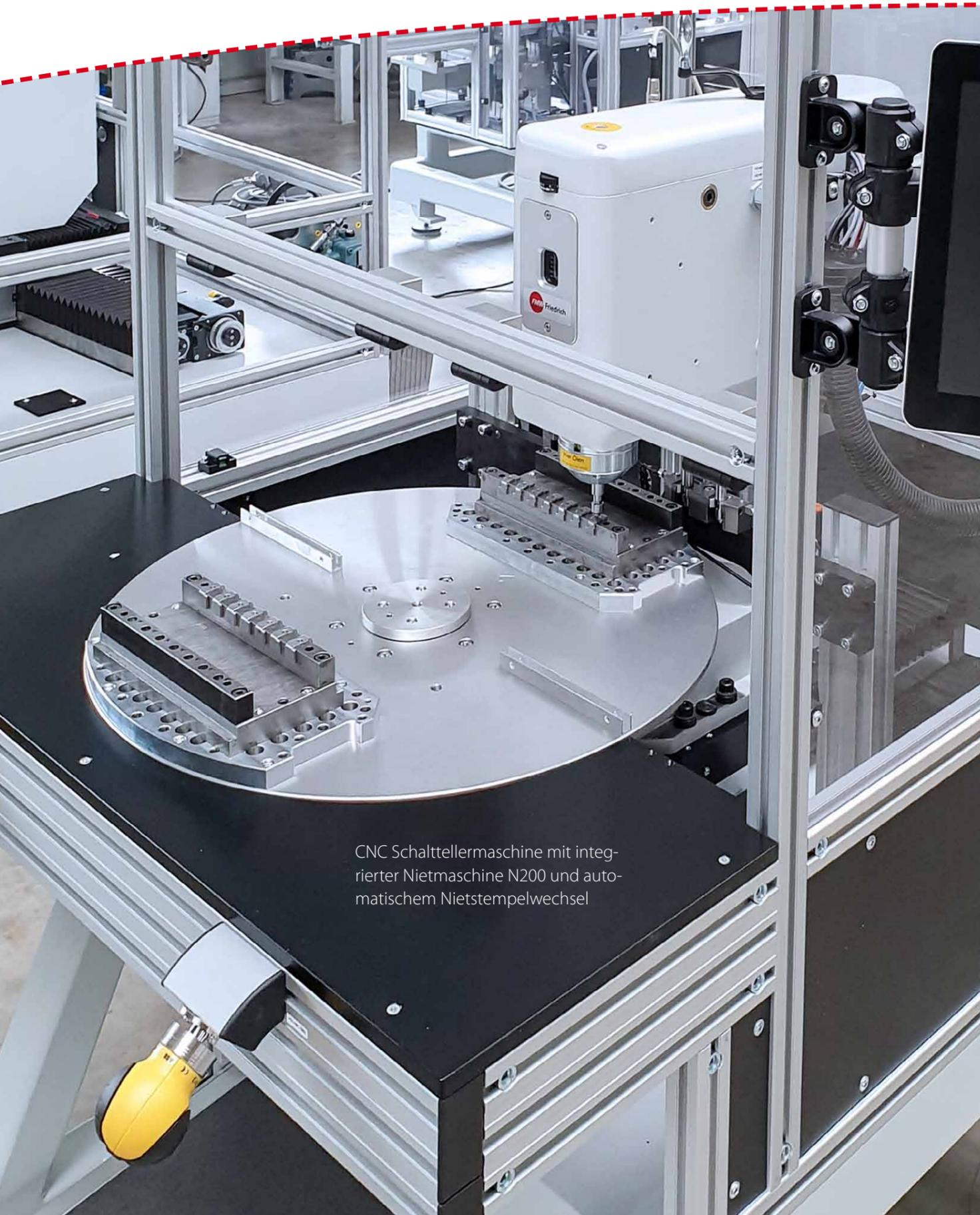
CNC Schalttellermaschine mit integrierter Nietmaschine N200 und automatischem Nietstempelwechsel
