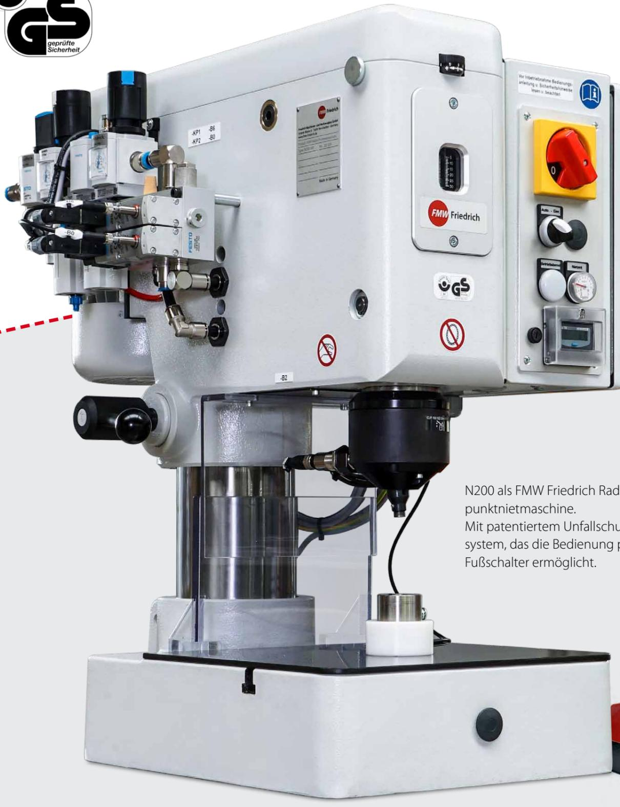
N200 als FMW Friedrich Radialpunkt-nietmaschine. Mit patentiertem Unfallschutzsystem, das die Bedienung per Fußschalter ermöglicht.
